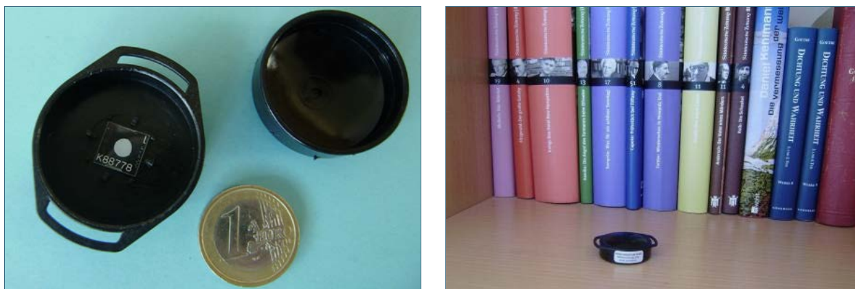
Abb. 3: Radon-Exposimeter: Ein Exposimeter mit einer genauen Gebrauchsanweisung erhalten Sie von den jeweiligen Laboren und Messstellen.
